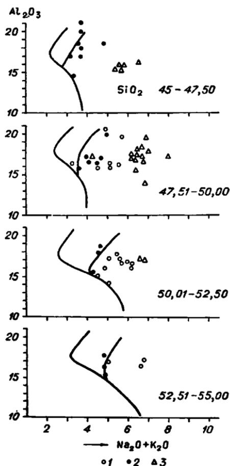
Рис. 2. Диаграмма соотношений  $Al_2O_3 - Na_2O + K_2O - SiO_2$  (по Куно) для базальтовых лав Армении.
