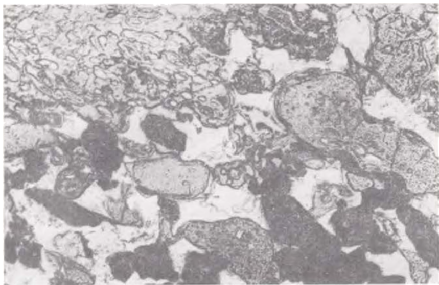
Рис. 21. Туф мелко-среднеобломочный. Видна ориентировка вытянутых обломков стекла и параллельное размещение сплюснутых пустот в обломке справа. Цемент анальцимопый. Структура литовитрокластическая. Николи I, X 50, скв. 14-СП, глб. 295,5 м.
