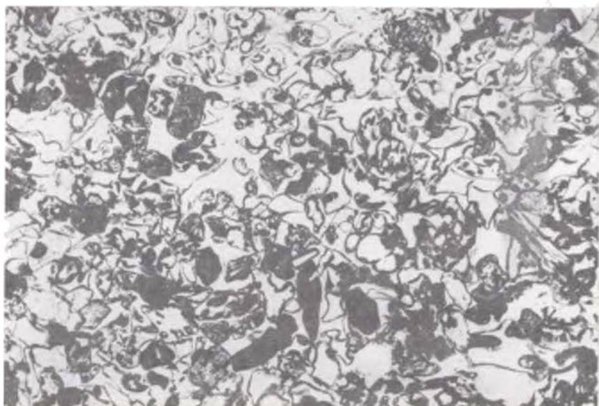
Рис. 24. Туф базальтовый мелко-тонкообломочный с причудливыми по форме обломками пепла. Часть обломков (черные) полностью окислена. Николаи, № 50, скв. Горохов.
