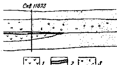
Рис. 33. Геологический разрез района с. Гусятина, показывающий пыветрелую поверхность базальтов, перекрытых песчаными отложениями: 1 — базальты; 2 — красная глина; 3 — пески, песчаники, алевролиты.
