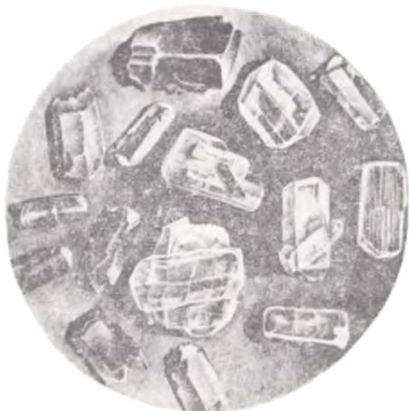
Рис. 39. Выделенные из балаклавского туфа кристаллы плагиоклаза, авгита и роговой обманки под биноклем, \times 25 .
