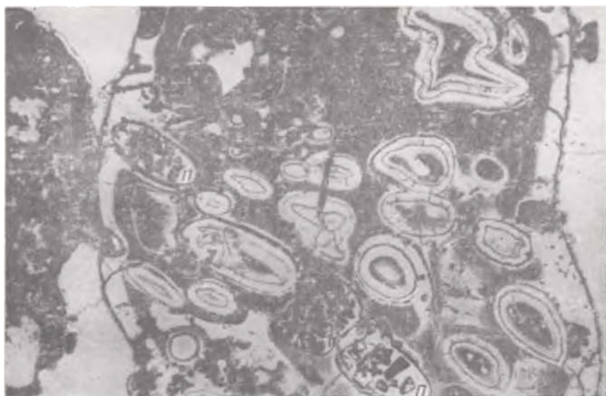
Рис. 23. Обломок желтовато-зеленого стекла из среднеобломочного туфа. Видны многочисленные округлые и овальные «пузыри», выполненные цеолитами. По периферии пустоты окаймлены слабодвупреломляющим или радиально-лучистым хлоритом. Николи 1, \times 80 , скв. 3-СП, глуб. 416,7 м.
