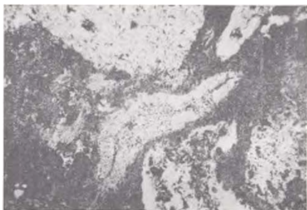
Рис. 45. Пепловая структура кварцевого порфира (скв. Ладинка-231) Николи J, \times 100 .
