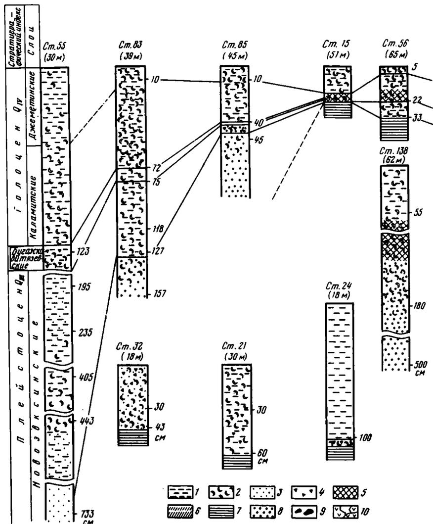
Рис. 3. Схема сопоставления колонок позднечетвертичных отложений Одесско-Дунайского разреза
