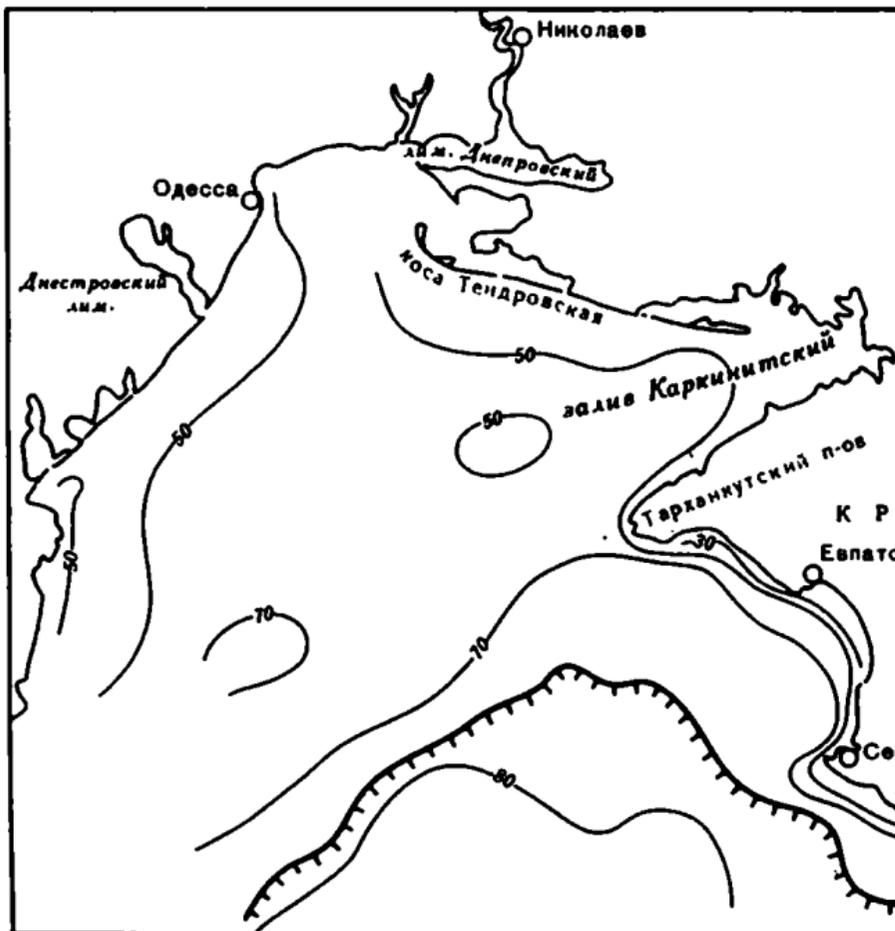
Рис. 20. Распределение (в %) терригенных частиц пелитовой (менее 0,01 мм) размерности в джеметинских осадках дна северной части Черного моря
