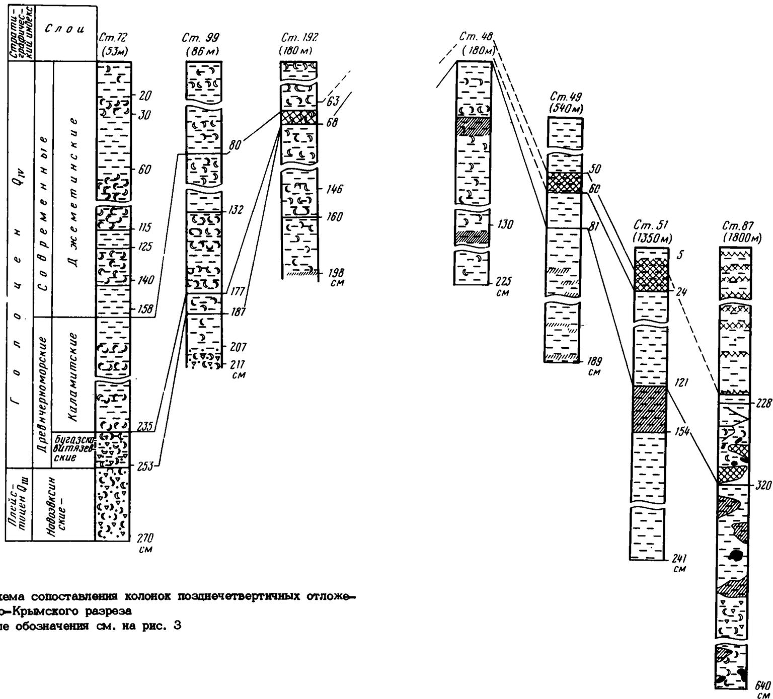
Рис. 8. Схема сопоставления колонок позднечетвертичных отложений Западно-Крымского разреза
