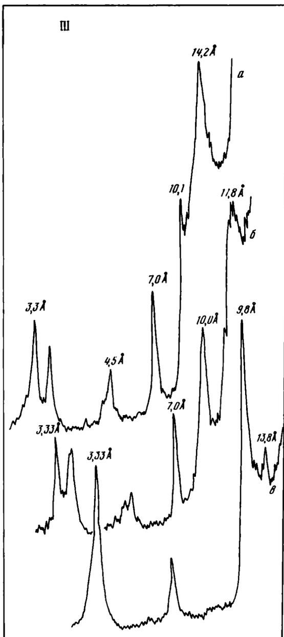
Препараты: а - ориентированный, б - насыщенный глицерином или этилен-гликолем, в - прокаленный в течение 1,5 часов при 550°C
