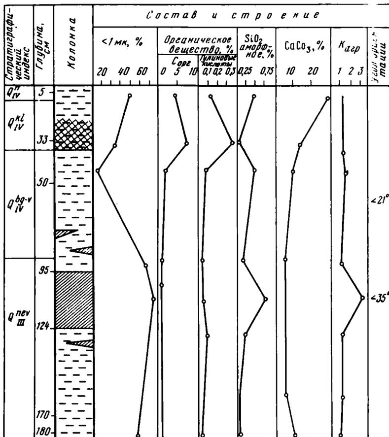
Рис. 35. Изменение физико-механических свойств по колонке позднечетвертичных осадков подножия континентального склона северо-западной части Черного моря
