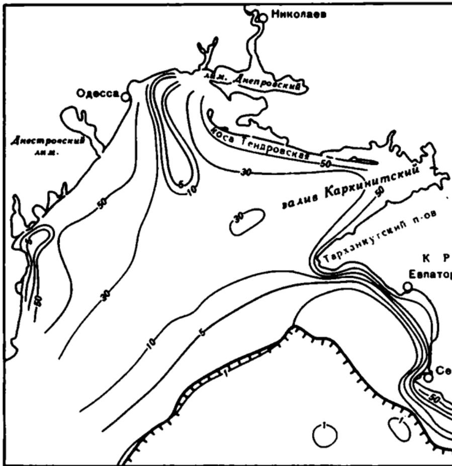
Рис. 18. Распределение (в %) терригенных частиц песчаной (более 0,1 мм) размерности в днепропетровских осадках дна северной части Черного моря
