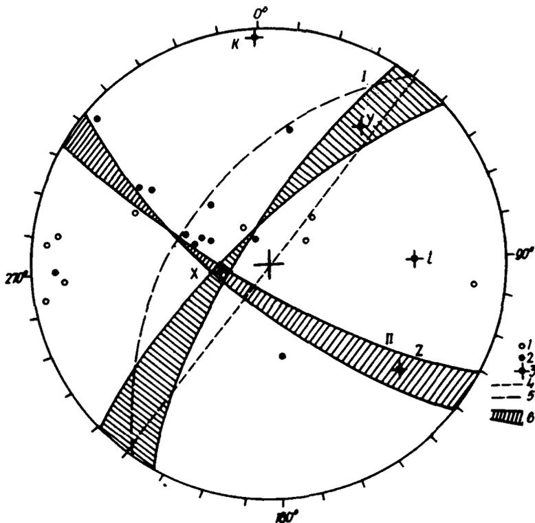
Рис. 30. Механизм очага землетрясения 6 августа 1972 г.: волны: 1 - растяжения, 2 - сжатия; 3 - оси напряжений; ориентация разрыва: 4 - по изосейстам, 5 - по данным работ [37]; 6 - области погрешностей положения нодальных плоскостей I, II, определенные по знакам вступления  $p$ -волн
