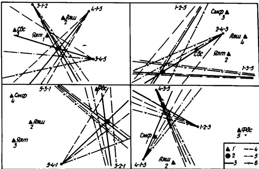
Рис. 7. Схема определения эпицентров условных очагов способом эпицентралей:
