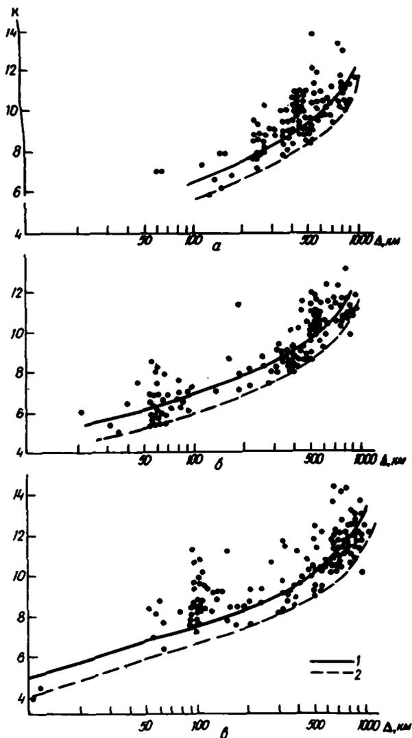
Рис. 13. Графики представительности (1) и дальности регистрации (2) высокочувствительных станций I этапа инструментальных наблюдений: α - скважинный пункт "Донузлав"; β - высокочувствительная аппаратура станции "Севастополь"; δ - скважинный пункт "Феодосийский"
