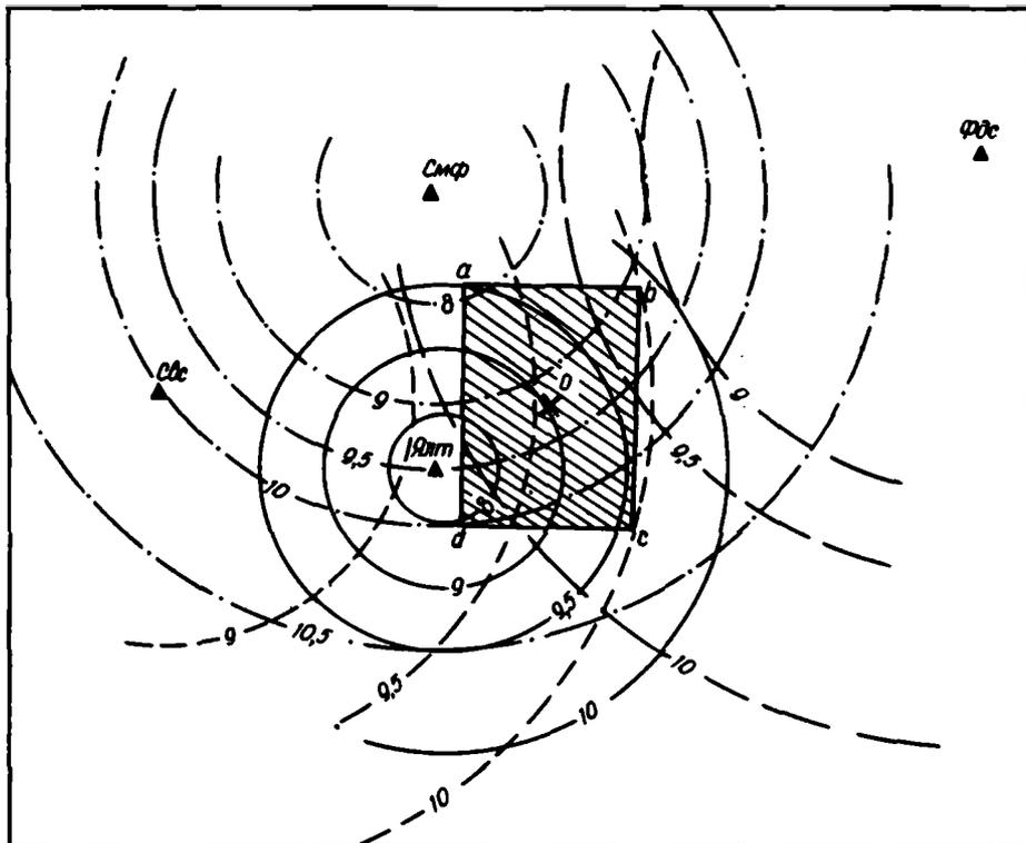
Рис. 21. Пример определения энергетического класса по графикам представительства землетрясений
