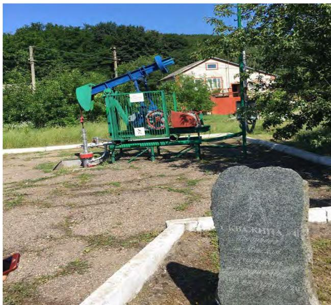
Рис. 1. Скважина, пробуренная в 1884 г., до сих пор работает с дебитом 200л/сутки (пос. Ильский)
