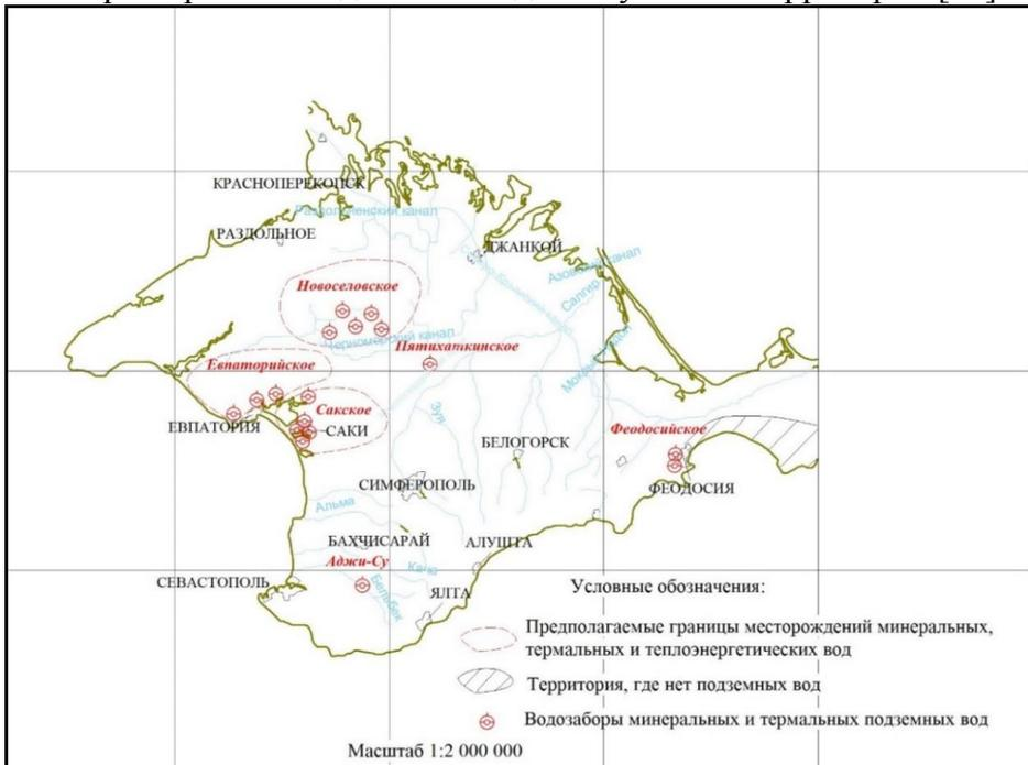
Рисунок 9.3. Схема расположения месторождений и водозаборов минеральных и термальных подземных вод на изучаемой территории [96, 97]
