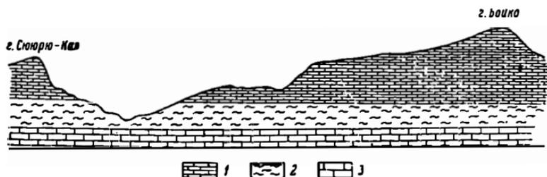
Рис. 11. Схематический геологический профиль через Сьюрю-Кая и Большой Крымский каньон.
