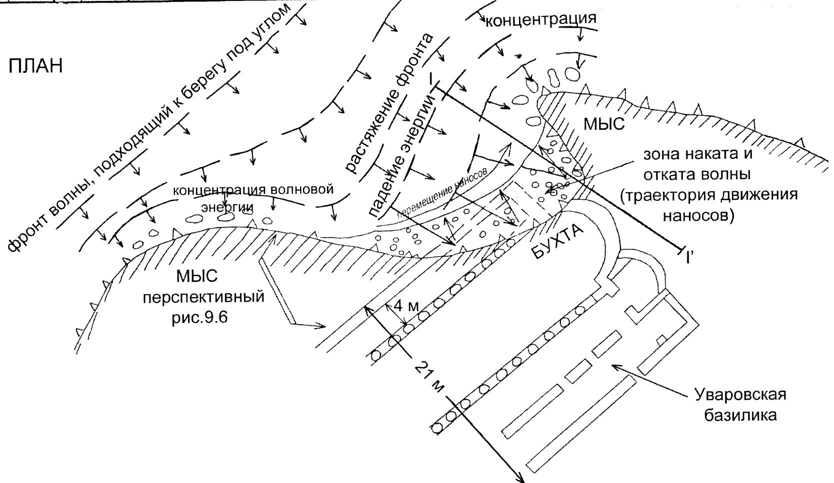
Рис.10.5. Перераспределение волновой энергии прибрежья и вдольбереговое перемещение наносов на мысах и в бухтах абразионного побережья. Обрушение части Уваровской базилики в береговой зоне. Херсонес
