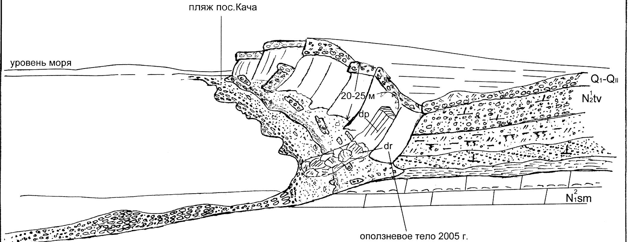
Рис.11.5. Строение абразионного побережья с оползневыми и обвальными накоплениями июля 2005 г. на пляже пос.Кача, повлекшими человеческие жертвы
