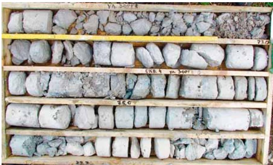
Рис. П28. Керн скважины 4 (г. Москва, СЗАО, ул. Зорге, 9). Интервал 71,6-78,5 м. Фото Р.Р. Габдуллина
