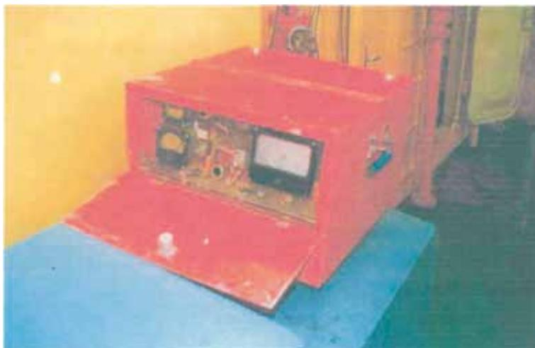
Рис. 1.2.34. Набортная часть электроискровой установки – накопитель энергии с системой управления. Габариты – 50х50х35 см, вес – 25 кг (Отчет..., 2004)
