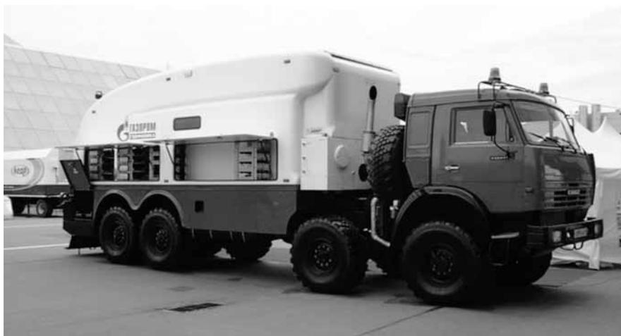
Рис. 1.2.27. Совместный проект «Газпром геофизики» и голландской компании ASEP – геофизический подъемник «Unitruck» на шасси полноприводного автомобиля КАМАЗ-63501–0001025. Вид сбоку. (<http://www.spectechnika.com/ru/filling/y-2010.n-3.oid-120.html>)
