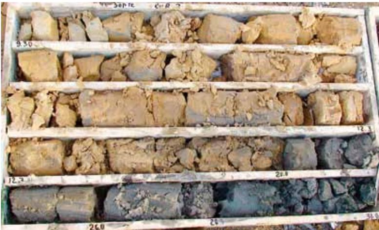
Рис. П6. Керн скважины 2 (г. Москва, СЗАО, ул. Зорге, 9). Интервал 9,30-31,8 м. Фото Р.Р. Габдуллина
