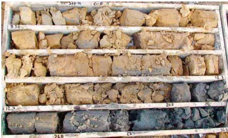
Рис. П7. Керн скважины 2 (г. Москва, СЗАО, ул. Зорге, 9). Интервал 31,8-36,8 м. Фото Р.Р. Габдуллина
