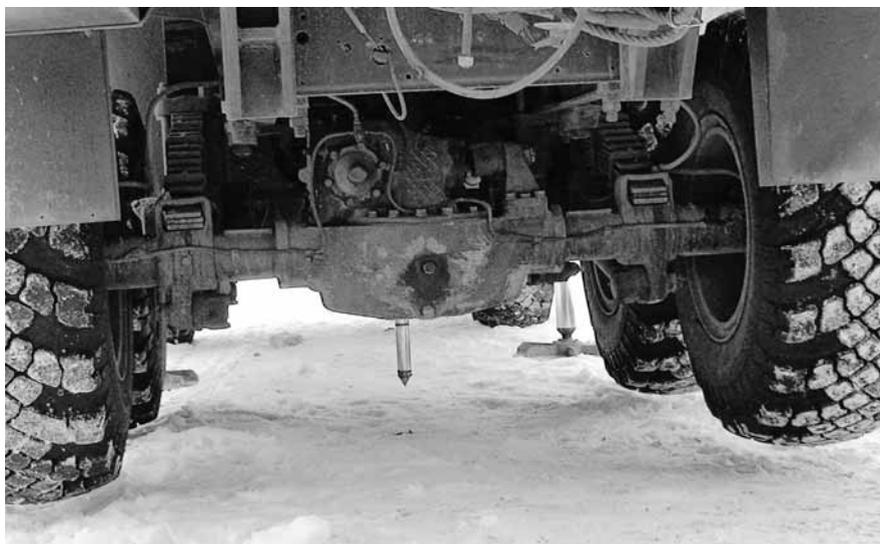
Рис. 1.2.52. Зонд установки «ФУГРО» (в центре) перед началом работы на площадке инженерно-геологических изысканий (г. Москва, ЮАО, ул. Чертановская, вл. 59А в феврале 2008 г. (публикуется с разрешения компании FUGRO))
