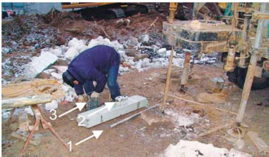
Рис. 1.2.17. Подготовка гамма-каротажного зонда к работе на площадке инженерно-геологических изысканий по (г. Москва, ЗАО, ул. Кульнева, д. 2) сотрудником ООО «ЦГИ» Андреевым М.А.: 1 – зонд (скважинный снаряд); 2 – наземная аппаратура; 3 – катушка с кабелем. Фото Р.Р. Габдуллина
