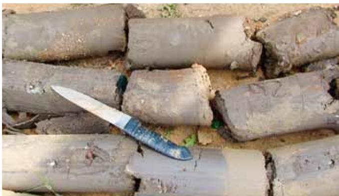
Рис. 1.2.45. Керн нижнеплейстоценовых отложений ( $gQ_1 dn$ ). Ледниковые отбразования (морена) донского оледенения. Коричнево-серые полутвердые и тугопластичные суглинки с гравием и галькой кремня и известняков (г. Москва, ЮЗАО, Щербинка, Коммунальная зона, июнь 2008 г.)
