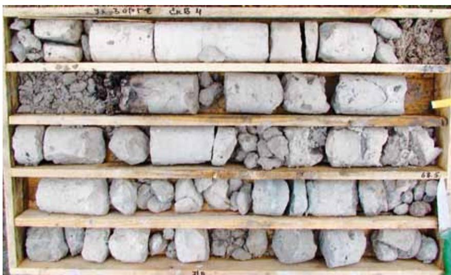
Рис. П27. Керн скважины 4 (г. Москва, СЗАО, ул. Зорге, 9). Интервал 63,5-71,7 м. Фото Р.Р. Габдуллина
