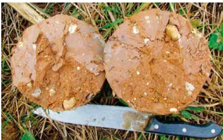
Рис. 1.2.48. Керн среднеплейстоценовых отложений ( $gQ_{II}ms$ ) в поперечном разрезе. Ледниковые отложения (морена) московского оледенения. Коричнево-красно-бурые полутвердые и твердые суглинки в поперечном разрезе (г. Москва, ЮЗАО, ул. Генерала Тюленева, вл. 4а). Видны гравий и галька кварца, кремня, известняков
