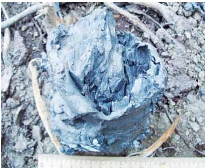
Рис. 3.2.30. Керн из толщи деформированных оползнями пород – брекчированная глина со щебнем мергелей
