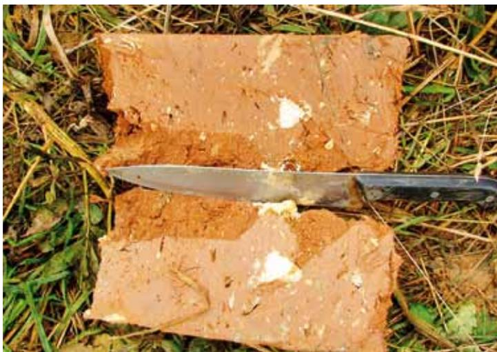
Рис. 1.2.47. Керн среднеплейстоценовых отложений ( $gQ_{II}ms$ ) в продольном разрезе. Ледниковые отложения (морена) московского оледенения. Коричнево-красно-бурые полутвердые и твердые суглинки в продольном разрезе (г. Москва, ЮЗАО, ул. Генерала Тюленева, вл. 4а, сентябрь 2010 г.). Видны гравий и галька кварца, кремня, известняков
