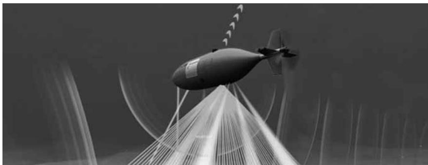
Рис. 1.2.30. Автономный мобильный подводный модуль «сканирует» поверхностные слои осадка и передает информацию в управляющий центр на корабль-носитель ([www.fugro.com](http://www.fugro.com))
