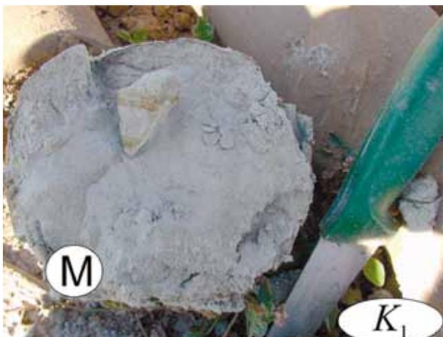
Рис. 1.2.43. Нижнемеловой морской серовато-зеленый песок мелкий, глауконитовый, слюдястый, водонасыщенный, плотный (г. Москва, ЮЗАО, Щербинка, Коммунальная зона, июнь 2008 г.)
