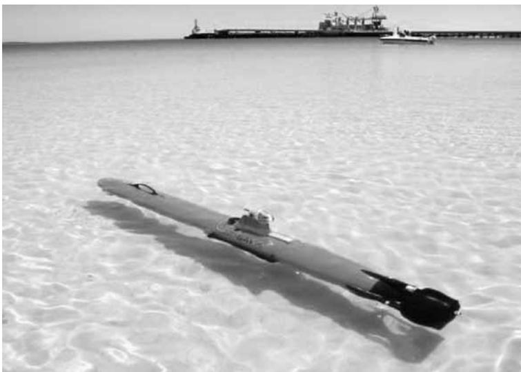
Рис. 1.2.29. Автономный мобильный подводный модуль Gavia AUV ([www.fugro.com](http://www.fugro.com))
