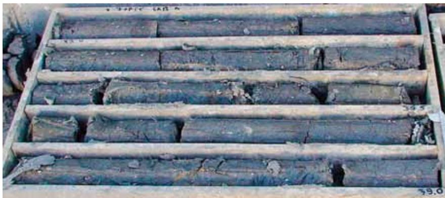
Рис. П30. Керн скважины 6 (г. Москва, СЗАО, ул. Зорге, 9). Интервал 33,4-39,0 м. Фото Р.Р. Габдуллина
