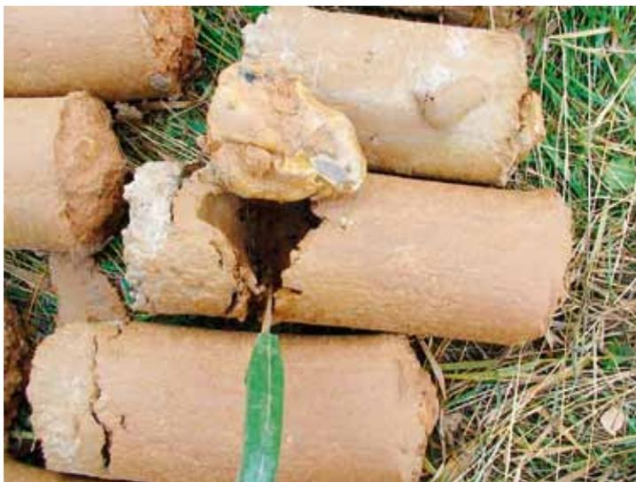
Рис. 1.2.50. Керн среднеплейстоценовых отложений ( $flgQ_{II}$  ms). Флювиогляциальные (водно-ледниковые) образования московского межледникового. Коричнево-красно-бурые и бурые супеси пластичные (верхний ряд), суглинки твердые (центр, нижний ряд) (г. Москва, ЮЗАО, ул. Генерала Тюленева, вл. 4а, сентябрь 2010 г.). Видна единичная крупная галька кремня
