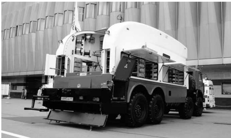
Рис. 1.2.26. Совместный проект «Газпром геофизики» и голландской компании ASEP – геофизический подъемник «Unitruck» на шасси полноприводного автомобиля КАМАЗ-63501–0001025. Вид сзади. (<http://www.spectechnika.com/ru/filling/y-2010.n-3.oid-120.html>)
