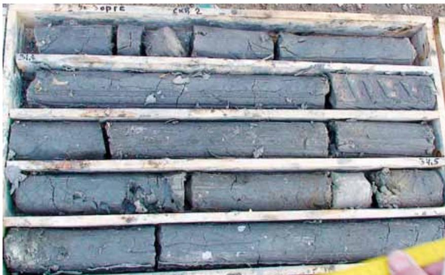
Рис. П8. Керн скважины 2 (г. Москва, СЗАО, ул. Зорге, 9). Интервал 36,8-42,6 м. Фото Р.Р. Габдуллина
