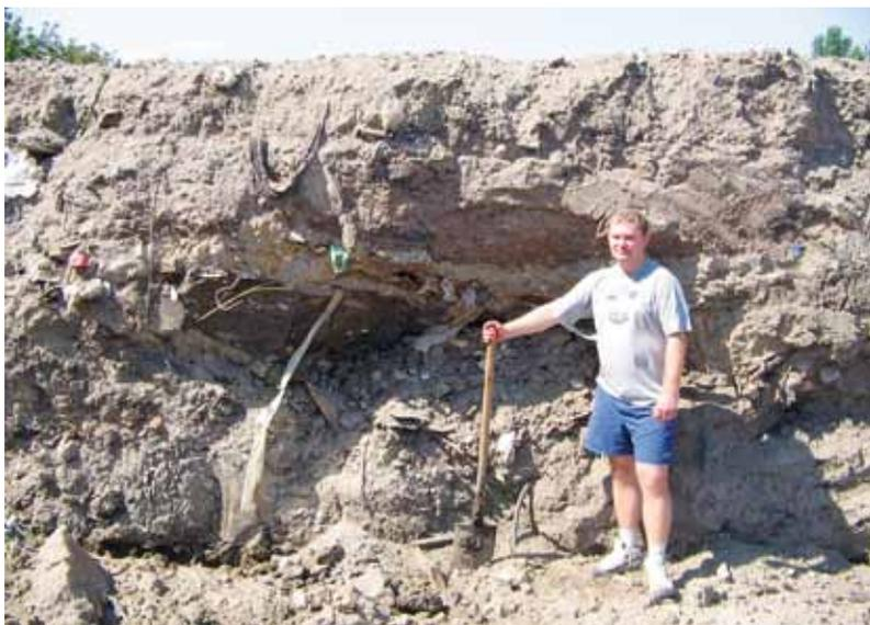
Рис. 3.3.11. Видимая мощность антропогенных грунтов, состоящих из технических и бытовых отходов (т.н. 35)
