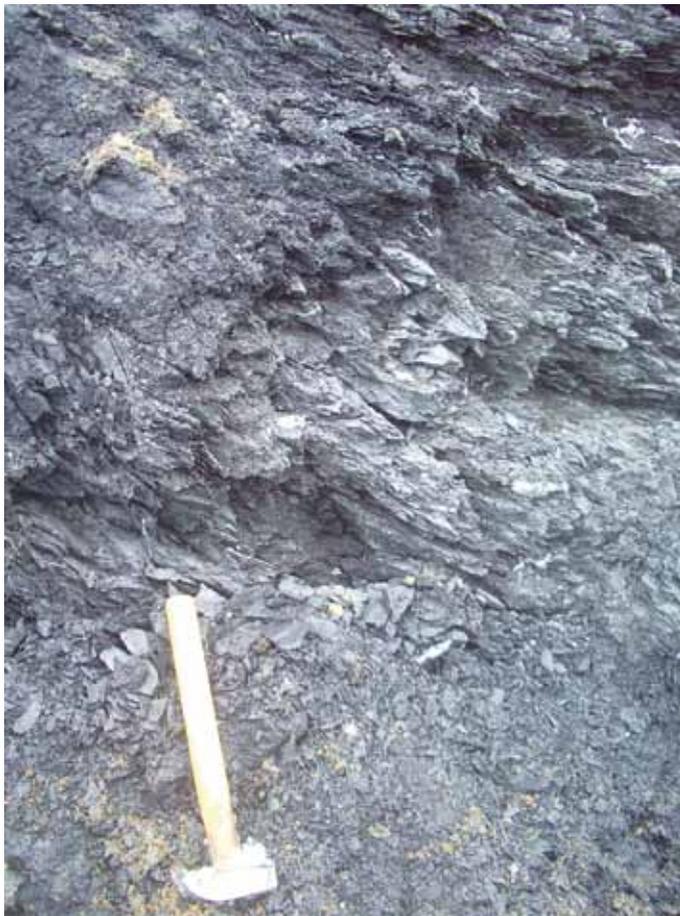
Рис. 3.2.15. Черные аргиллиты пониженной прочности чвежипсинской свиты ( $J_1cv$ ) в районе верхней посадочной станции канатной дороги хаб «Эсто-Садок» – комплекс трамплинов
