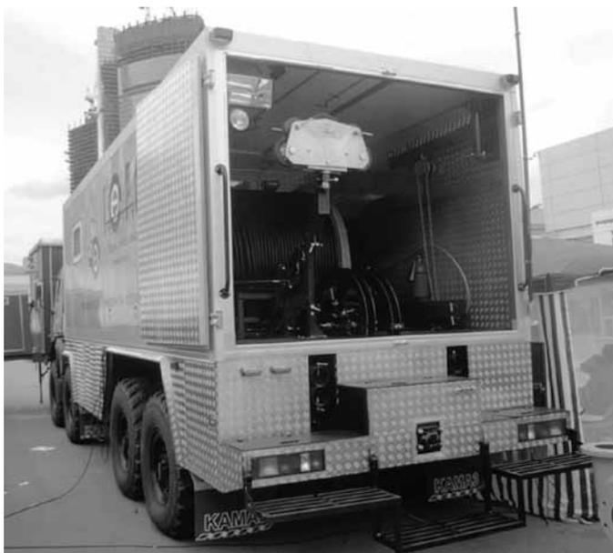
Рис. 1.2.28. Совместный проект компаний «ГИСприбор-М», «Псковгеокабель» и «ГЕРС» – геофизический подъемник с гидравлическим приводом ПКС-5Г-ГС на шасси полноприводного автомобиля КАМАЗ-6350 (<http://www.spectechnika.com/ru/filling/y-2010.n-3.oid-120.html>)
