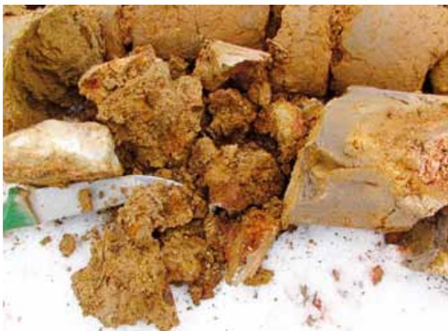
Рис. 1.2.44. Нижне- и среднелейстоценовые нерасчлененные отложения (fgl  $Q_{III}$  dn-ms). Флювиогляциальные (водно-ледниковые) образования московско-донского межледниковья. Пески мелкие желтовато-серого и желтовато-коричневого цвета, тонкослоистые за счет неравномерного ожелезнения, с редкой дресвой кварца и полевого шпата, средней плотности (г. Москва, ЮАО, ул. Чертановская, вл. 59А, февраль 2008 г.)
