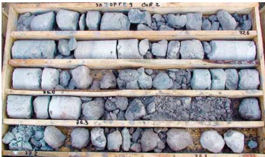
Рис. П13. Керн скважины 2 (г. Москва, СЗАО, ул. Зорге, 9). Интервал 70,7-78,5 м. Фото Р.Р. Габдуллина
