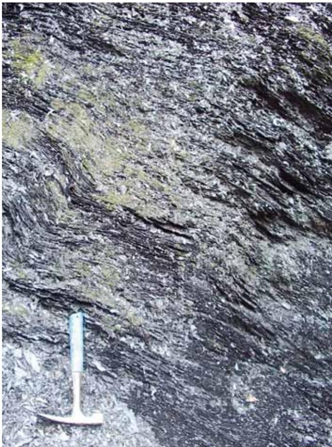
Рис. 3.2.21. Коренные выходы битуминозных аргиллитов графитово-серо-черных тонкочешуйчатых очень малопрочных, (эстосадокская-чвежипсинская свиты нерасчлененные) в т. 464
