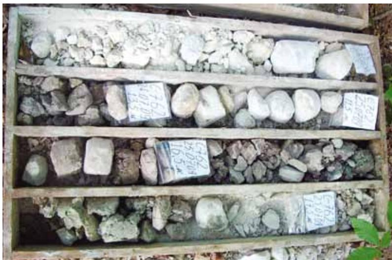
Рис. 3.2.6. Смещенные оползнем верхнеюрские известняки в керне скважины 762 (верхние два ряда, Абхазо-Рачинская тектоническая зона, Кепша)
