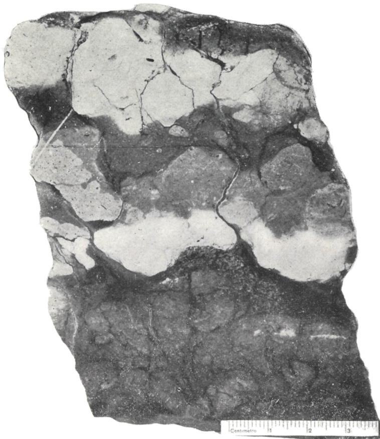
Fig. 1 - Calcare noduloso rosato (D22). La parte inferiore ha un contenuto più elevato in argilla con noduli piccoli, poco definiti dalla matrice, non amalgamati in noduli più grandi. Nella parte superiore i noduli sono di maggiore dimensione, composti, lateralmente compenetrati secondo superfici stilolitiche, più ricchi in  $\text{CaCO}_3$  (le parti più chiare sono di calcare bianco-verdastro).
