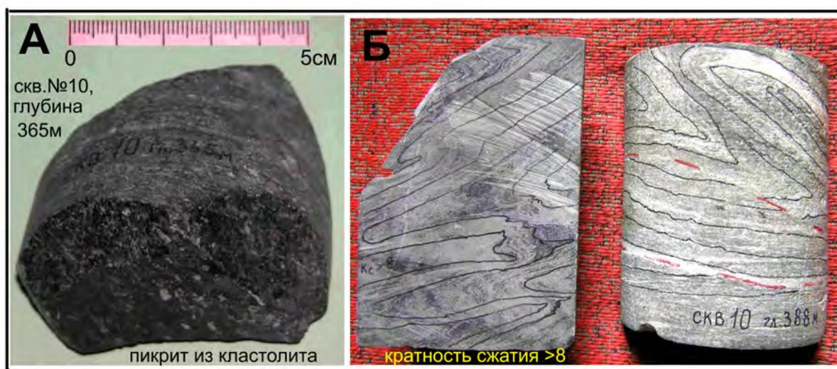
Рис. 2. Фрагмент керна глыбы мантийного ультрабазита (А) и вскрытые бурением ниже ее интенсивно смятые и сорванные надвигами динамометаморфические сланцы (Б)
