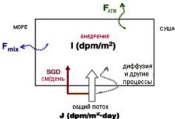
Рис 5.6. Концептуальная модель использования непрерывных наблюдений за концентрациями радона для оценки субмаринной разгрузки подземных вод [Barnett et al. 2006].
