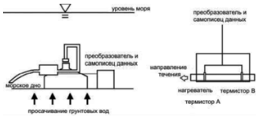
Рис. 12.5. Схема автоматического измерителя инфильтрации типа «постоянной высокой температуры» [Taniguchi et al., 2001].
